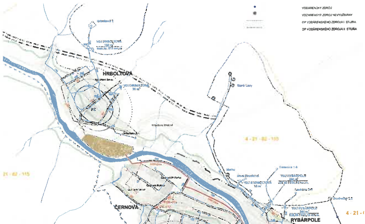
Obrázok 2 Situovanie vodárenských zdrojov, ich ochranné pásma a spôsob využitia podľa územnoplánovacej dokumentácie mesta Ružomberok (Výkres riešenia verejného technického vybavenia – vodné hospodárstvo)
