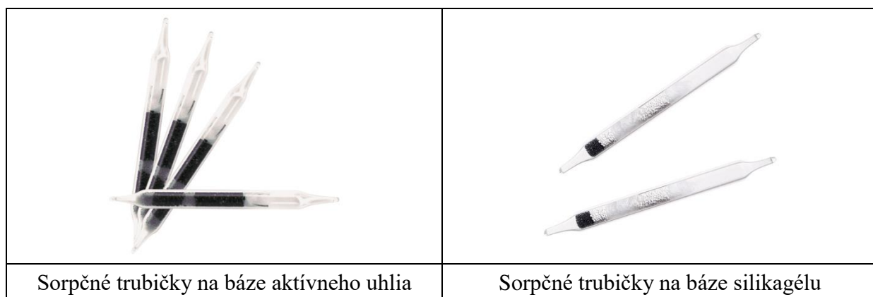
Obrázok 17. Príklady sorpčných trubičiek na odber vzoriek vzduchu z komerčnej prezentácie – sorpčné trubičky na báze aktívneho uhlia a na báze silikagélu
