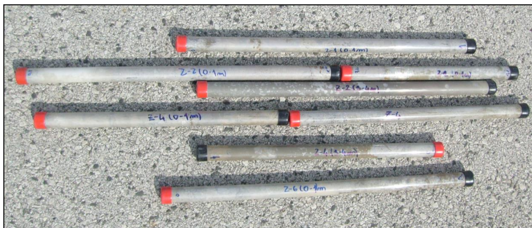
Obrázok 6. Vzorky nespevnených zemín zo zariadenia Geoprobe – utesnené PE trubice naplnené zeminou – odobraté s použitím vzorkovača LB Soil Sampler (ø 25 mm)
