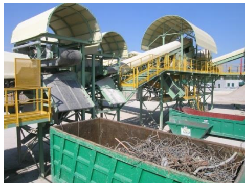
Zariadenie na recykláciu stavebného odpadu a odpadu z demolácie, zdroj: ANPAR.
