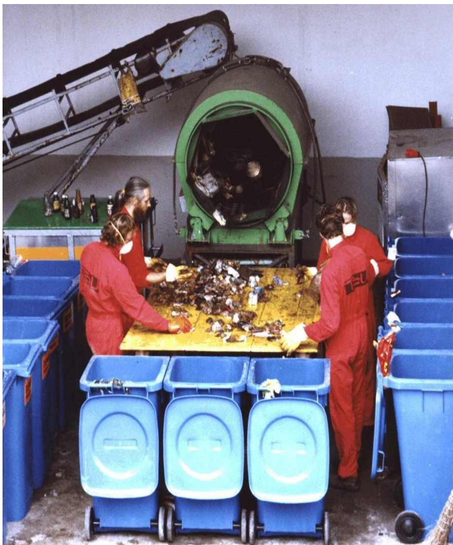
Obr. 6: Typické technické zariadenie hlavnej časti analytického procesu: Dopravník- sito – triedenie na 30 frakcií
