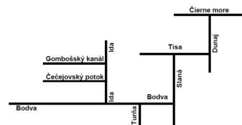
Obr. Chyba! Dokument neobsahuje žiadny text so zadaným štýlom..1 Schéma vodných tokov v čiastkovom povodí Bodvy s plochou povodia P \geq 100 \text{ km}^2
